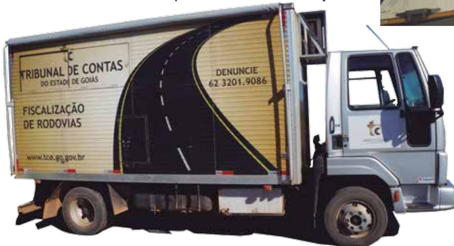
**O CAMINHÃO** – A estrutura do laboratório móvel é adequada para a realização de ensaios de solos e misturas asfálticas e controle tecnológico de materiais em obras de pavimentação. Montado na carroceria de um caminhão tipo baú, o equipamento tem a capacidade de percorrer todo o Estado de Goiás para subsidiar o corpo técnico de engenharia nos trabalhos de inspeções *in loco*, possibilitando uma fiscalização mais eficiente da qualidade dos serviços prestados nas obras de pavimentação asfáltica.
